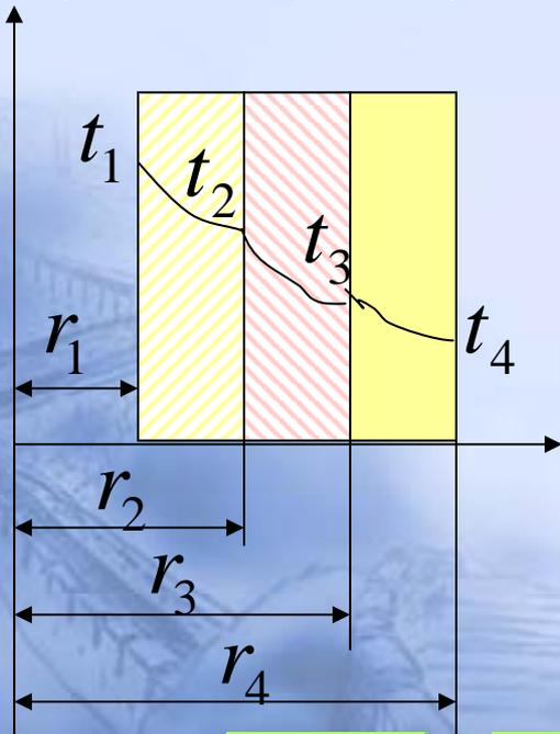
2、多层圆筒壁：热由多层圆筒壁内层传到最外壁，要依次经过各层，所以多层圆筒壁的导热过程可视为各单层圆筒壁串联进行的导热过程，单位时间内由多层壁所传导的热量，也就是经过各单层壁面所传导的热。
