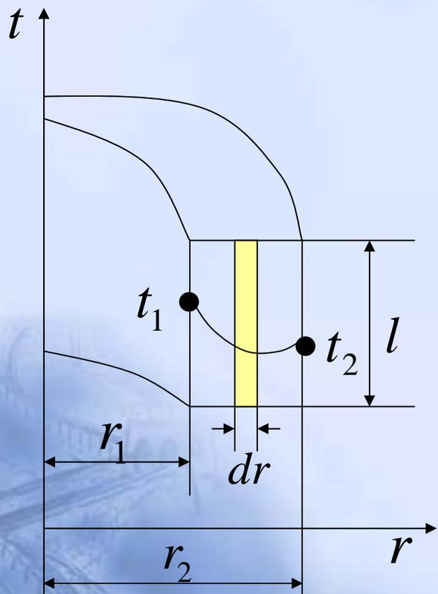
圆筒壁与平壁的不同点是其传热面积随半径( $A \sim r$ )而变化
